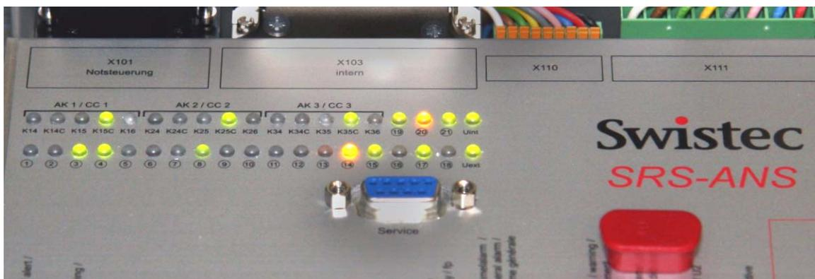
Die Zustände der wesentlichen Ein- und Ausgänge des SRS-ANS werden über Leuchtdioden visualisiert.
